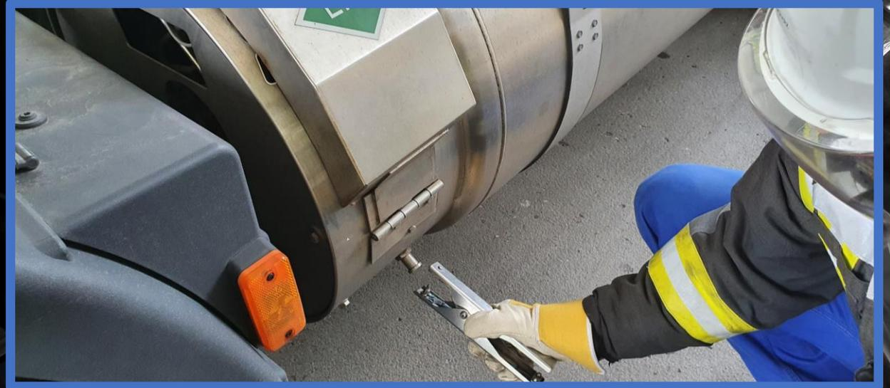
Überprüfen Sie den Druck Ihres LNG Tanks. Bei Volvo muss der Druck unter 8 bar liegen.
