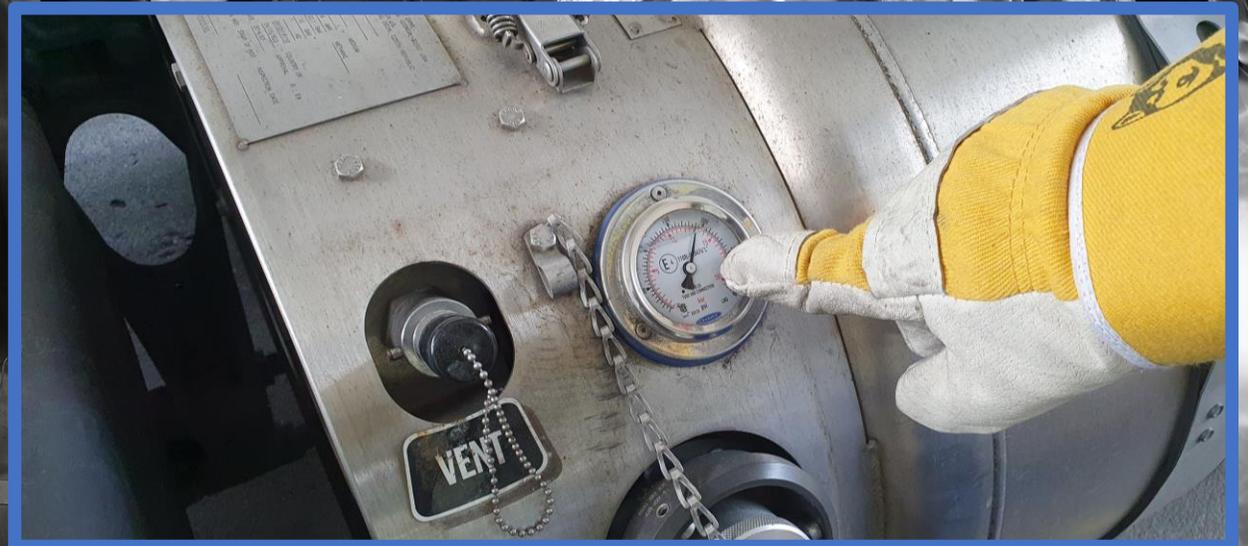
Säubern Sie die Füllkupplung mit der Blaspistole und schließen diese an den LNG Tank Ihres Fahrzeuges an.
