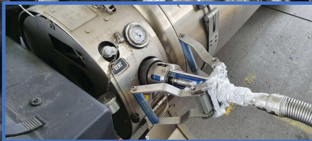
Reduzieren Sie den Druck ihres LNG Tanks auf unter 8 bar indem sie das Ventil öffnen.
