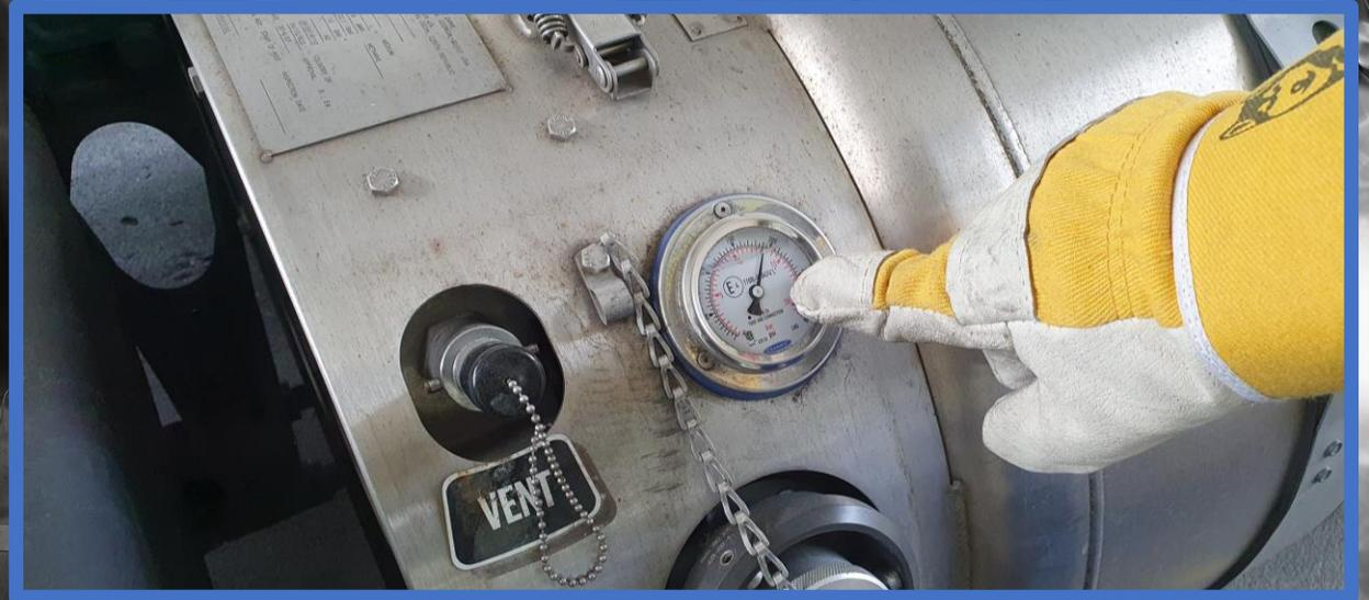
Säubern Sie die Füllkupplung mit der Blaspistole und schließen diese an den LNG Tank Ihres Fahrzeuges an.
