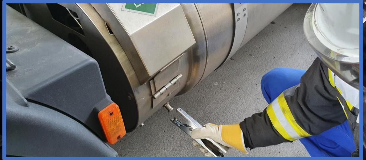
Überprüfen Sie den Druck Ihres LNG Tanks. Bei Volvo muss der Druck unter 8 bar liegen.
